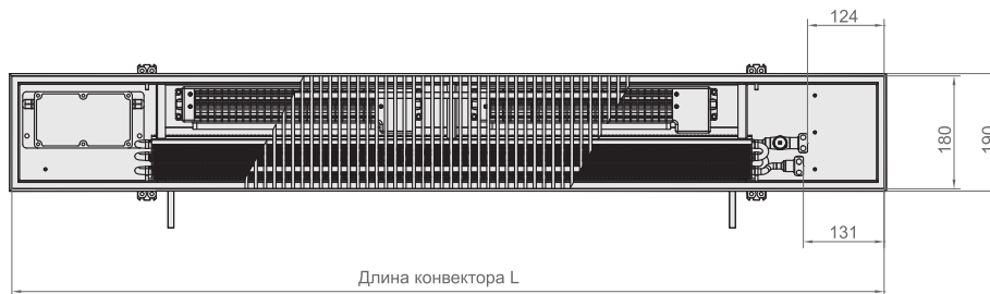
Вид сверху конвектора Qtherm НК Mini 190.90 с роликовой решеткой, с U-образным бортом.
