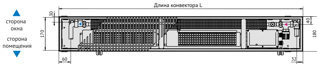
Вид сверху конвектора Qtherm 180 с роликовой решеткой, с U-образным бортом, с дренажом.
